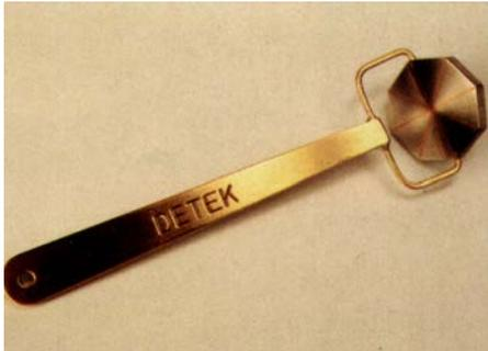
Le témoin ASME est un instrument portatif facile et rapide d'emploi. Il est le complément nécessaire de l'appareil de magnétoscopie pour vérifier l'efficacité du contrôle. Celle-ci dépend en effet de la géométrie de la pièce, de l'intensité du courant, de la distribution du champ, de la concentration et de la qualité du produit indicateur.
